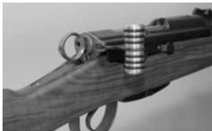
Bild 23: Riegelgriff anatomisch zu Karabiner und Langgewehr
