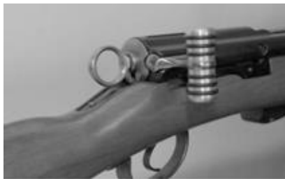
Bild 23: Riegelgriff anatomisch zu Karabiner und Langgewehr
