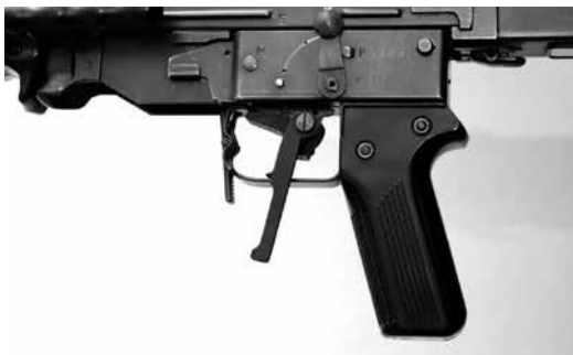
Bild 17: Winterabzug für Linksschützen zu Stgw 57
